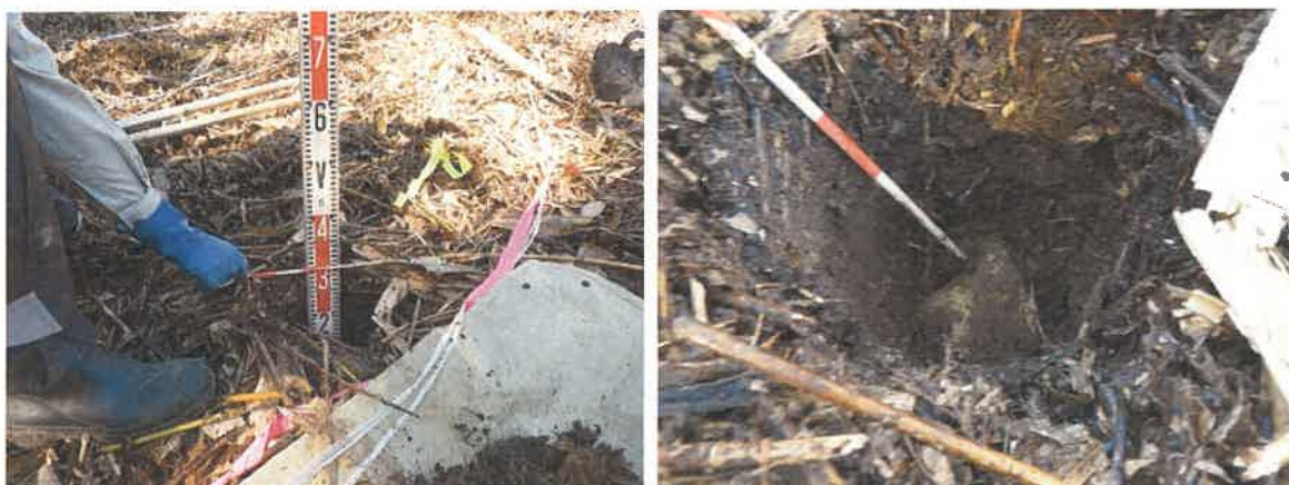
図 5.5 人力掘削による目視等による調査 調査結果例 (R6 調査範囲 : M57 (2 の 1)) (左 : 人力掘削後の孔, 右 : 孔底, 凝灰岩の転石の一部を確認)
