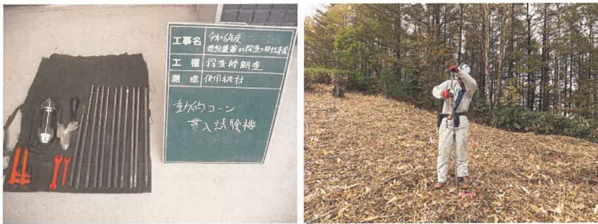
図 4.2 探査棒調査 使用機器の外観（左）と実施状況（右）
