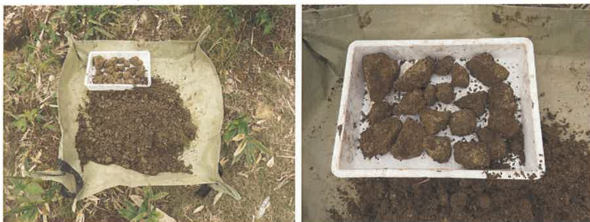
図 5.4 人力掘削による目視等による調査 調査結果例 (R5 事業範囲 : M12 (2 の 2)) (左 : 掘削した土砂, 右 : 土砂に含まれていた固形物, 凝灰岩の小礫のみ確認)
