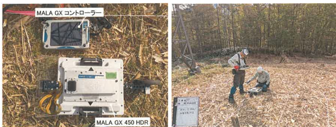
図 3.2 地中レーダー探査調査 使用機器の外観(左)と実施状況(右)
