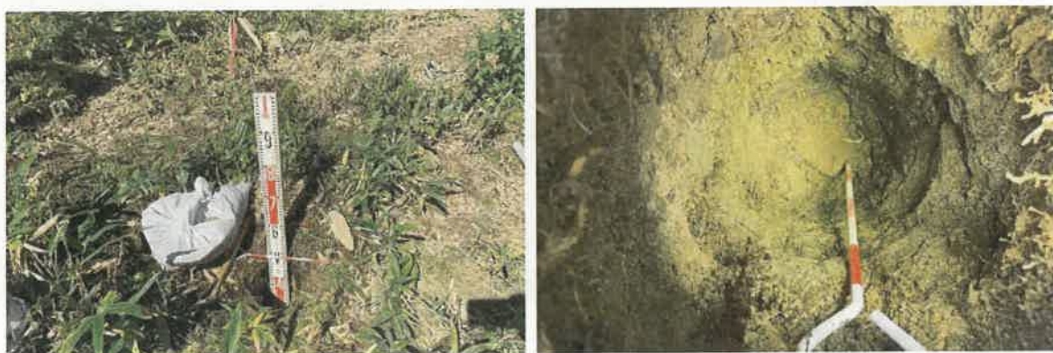
図 5.3 人力掘削による目視等による調査 調査結果例（R5 事業範囲：M12（2 の 1）） （左：人力掘削後の孔，右：孔底，凝灰岩の転石の一部を確認）
