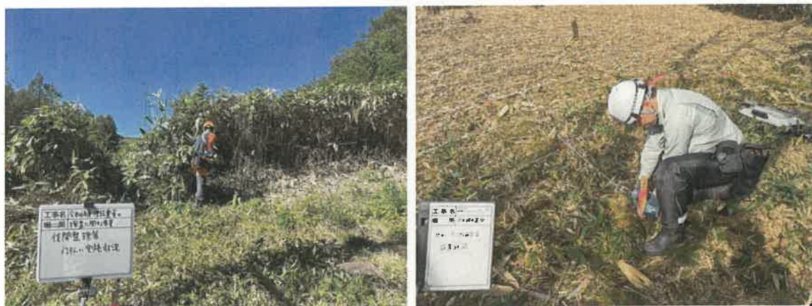
図 3.6 地中レーダー探査調査 実施状況(左:刈払い整理, 右:探査測線設置状況)
