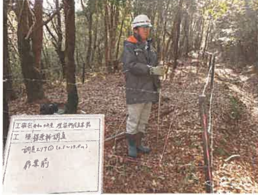
写真 2.5 探査棒調査状況（貫入中）
