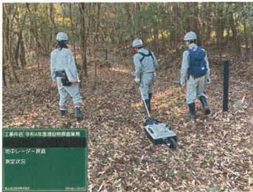
写真 2.1 地中レーダ探査状況（一次調査）
