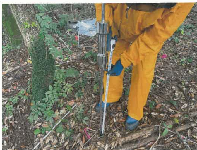
写真 4.1 探査棒貫入深度の計測状況
