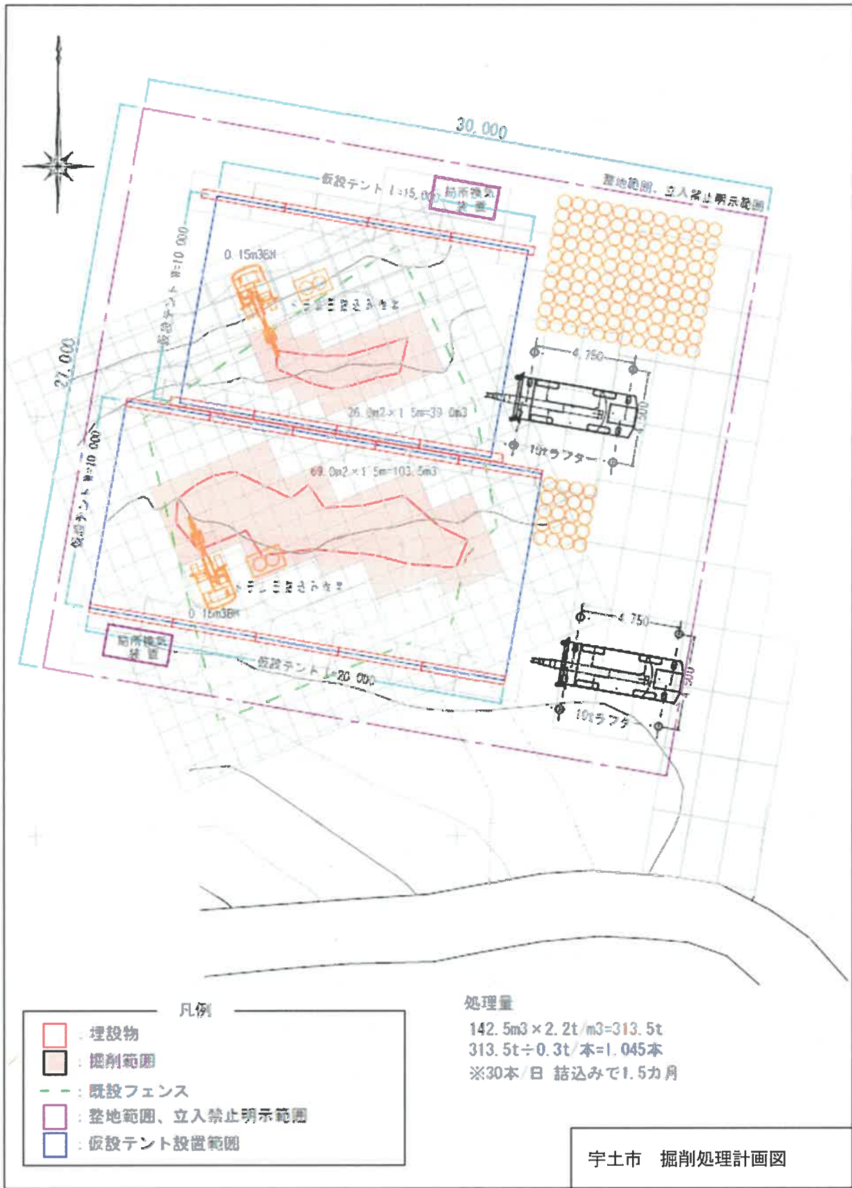
図 4-12 掘削処理計画図（熊本県宇土市）
