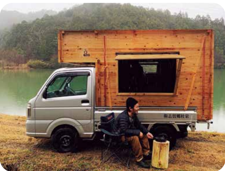
軽トラ設置型の木製キャンピングユニット
