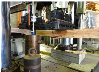
木材の強度試験（森林研究所）
