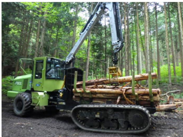
3 m材を積み込み中のフォワーダ (最大積載量は4.5トン)
