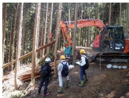
スイングヤーダ (リモコンによる集材作業)
