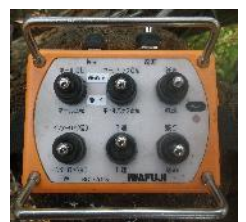
離れた場所からウインチの増減速やワイヤロープの張力操作が可能なりモコンの送信機
