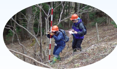
林業専用道予定路線をハンドレベルにて勾配を測りながら踏査
