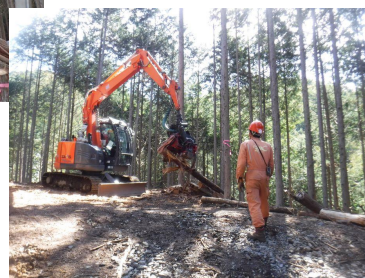
【右：ハーベスタ による造材作業】
