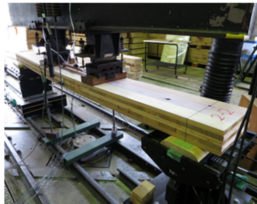
図2：フィンガー長さ6mmのマイクロフィンガージョイントでたて継ぎしたスギラミナを用いたCLTの曲げ試験の状況
