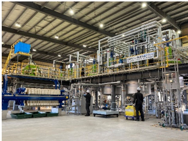
図1：改質リグニン製造プラント （製造規模：年間100トン以上）
