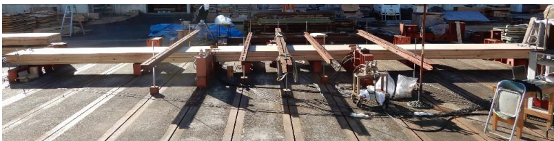
(図2) 枠組壁工法の国産材構造用複合部材 (スパン12mの梁部材)
