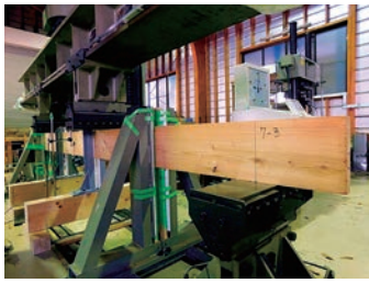
写真8-4 カラマツ2×10材の 曲げ強度試験の様子
