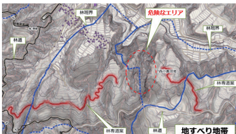
危険地形を回避したルート
