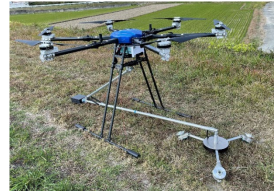
特殊刈払機を装着したドローン
