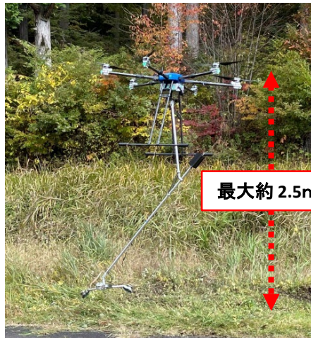
下刈り作業実証試験の様子
