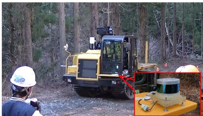
遠隔操作による走行と3D-LiDARによる路面のスキヤニング
