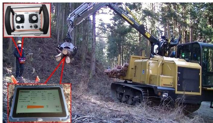
遠隔操作による材の積込作業
