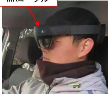
MR技術とリモコンを活用して油圧式集材機とグラップルを遠隔操作。右の画像は、MRゴーグルに映る作業現場と架線式グラップルの3DCG映像。
