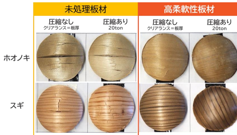
図1 処理材の絞り加工試験結果(未処理材との比較)
