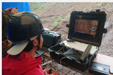
カメラ映像による 遠隔操作の実施
