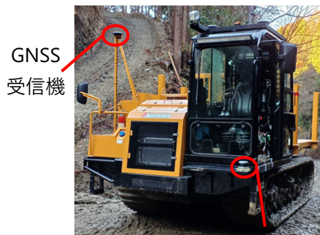
丸太を積載して上り坂を自動走行 (R5年度事業成果より)
