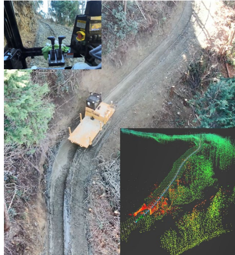
急勾配やS字カーブ等を含む約450mの森林作業道の自動走行に成功
