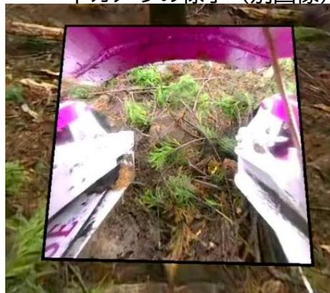
クランプ下カメラの映像は上カメラと同じ画面内で見られます。目線を下側に向けると自動的に下カメラの映像が拡大表示されます。
