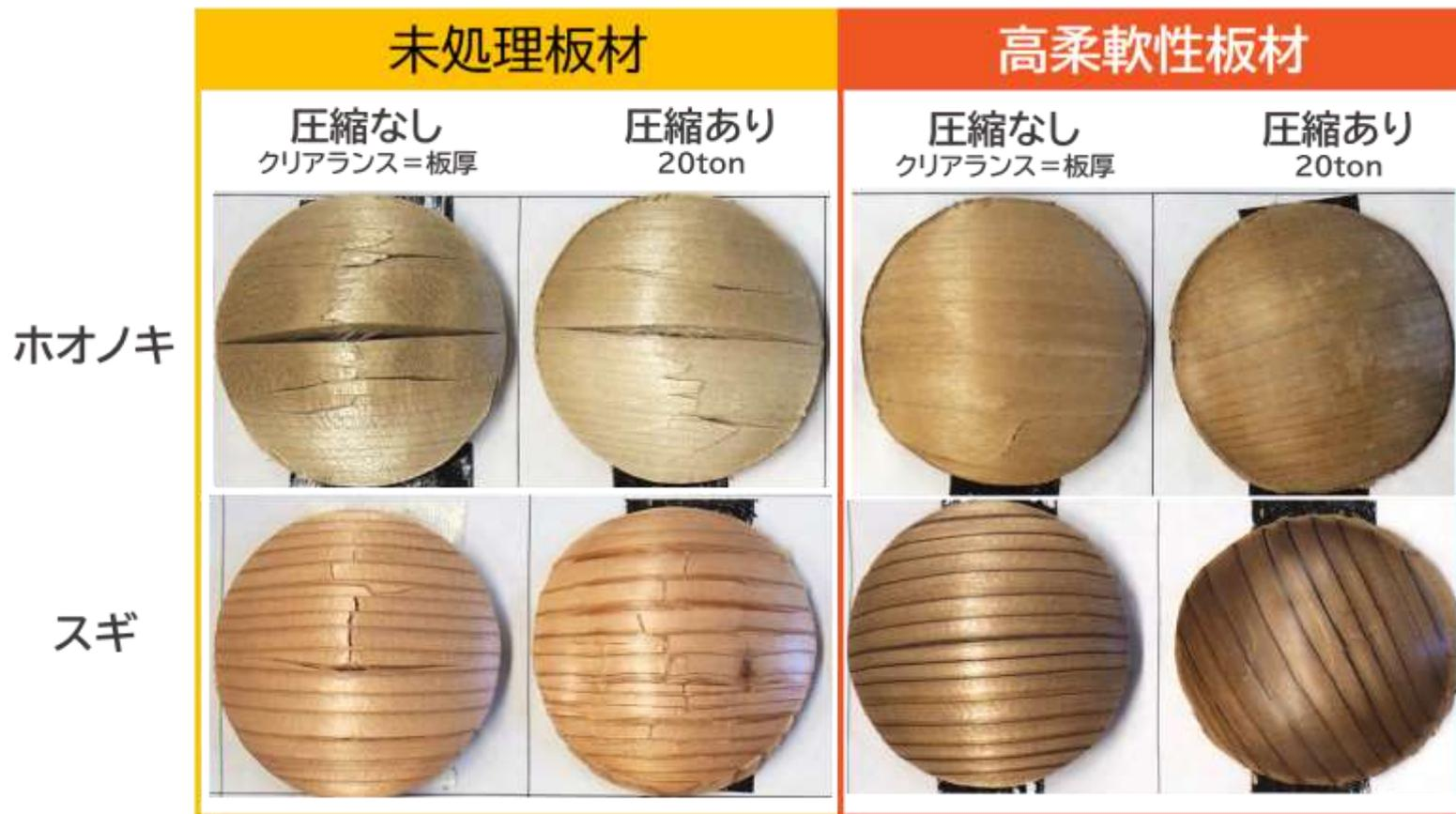
処理材のプレス成形(絞り加工)試験結果 -未処理材との比較-
