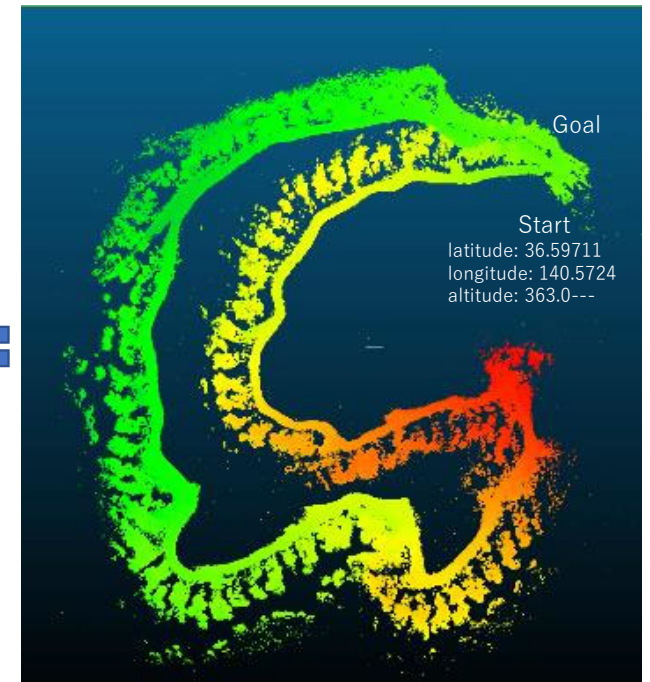
・ 3D点群地図[GNSS補正後]
