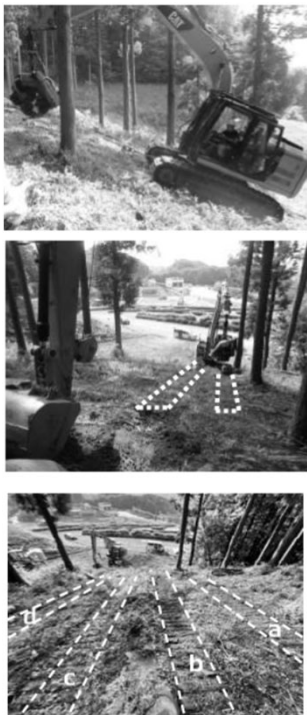
【土壌・植生に与える影響の評価】 ~検証1~ 往復走行試験による攪乱と回復 (埼玉県秩父市_スギ林・褐色森林土)
