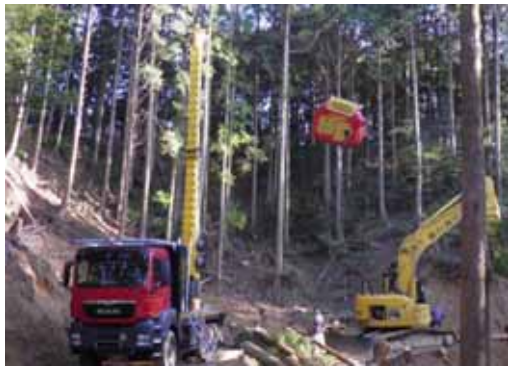
大型タワーヤードでの集材作業
