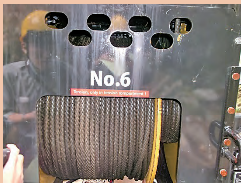
タワーヤードの主索用ドラム
