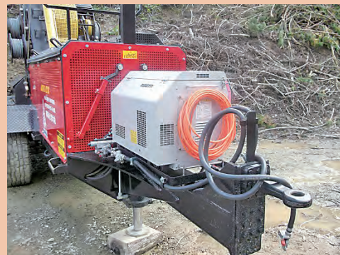
追加されたエアブレーキ用コンプレッサ
