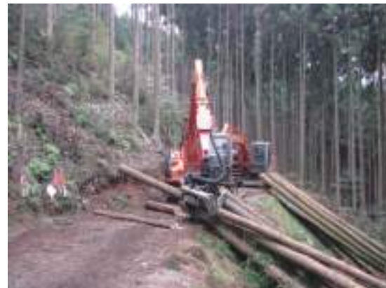
作業ポイントで荷外しされた集材木を造材
