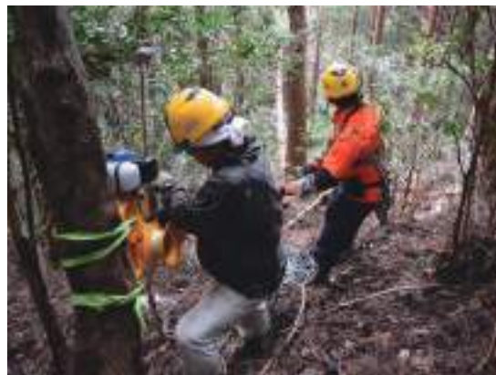
小型ウインチによる予備線の巻き取り
