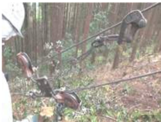
かくせんき 掴線器を用いた搬器の係留
