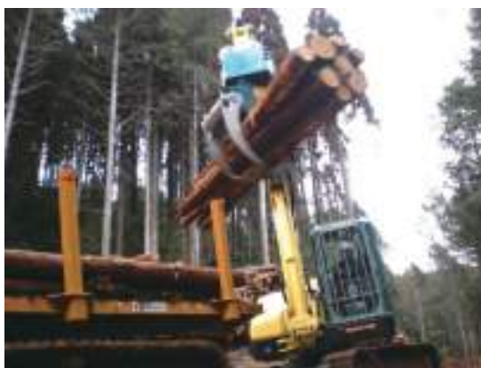
グラップルによるフォワーダへの積込み
