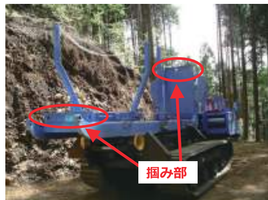
荷台幅低減機構を搭載したコンテナ
