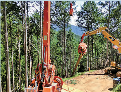
高性能搬器と組み合わせた索張り方式
