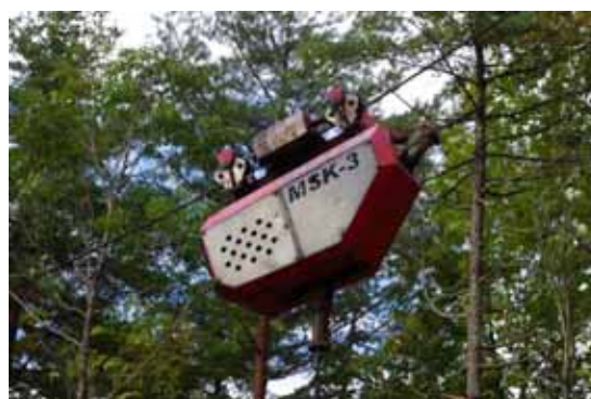
自動繫留搬器（機械油圧式）
