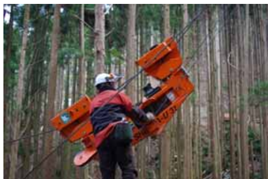
搬器を降ろして点検を実施
