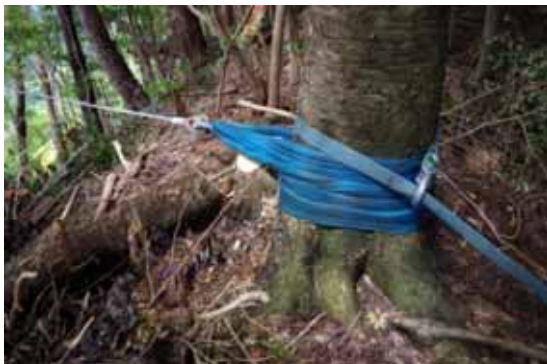
ラウンドスリング等を用いたアンカーの作設
