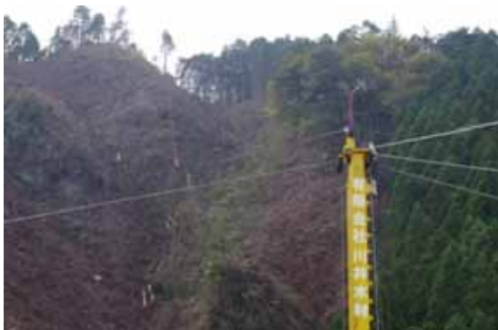
谷越し地形に架設して架線高を確保
