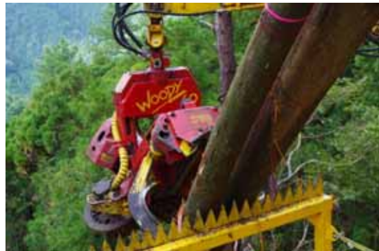
滑落防止柵を用いて掴み易くする
