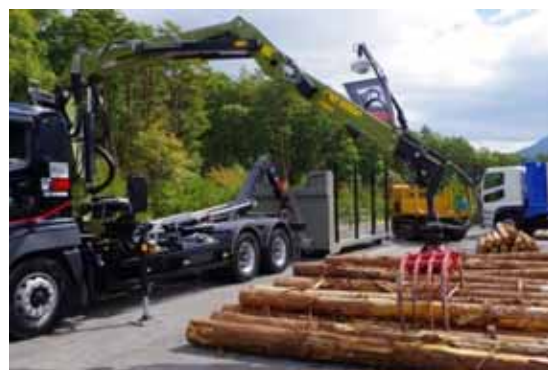
荷台が脱着可能な大型トラック
