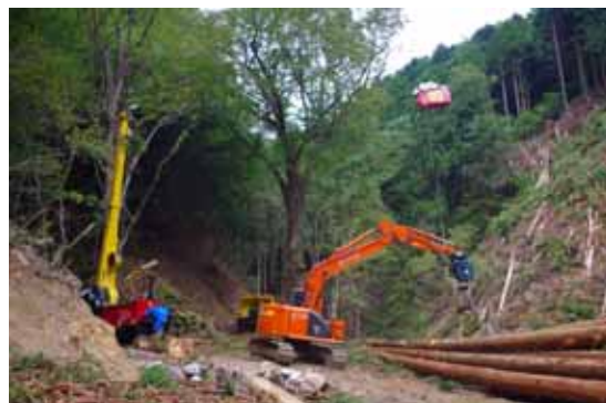
自走式搬器を用いた集材作業
