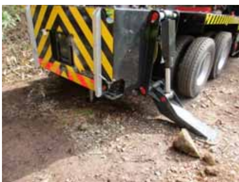
アウトリガーとセンターリガーによる固定
