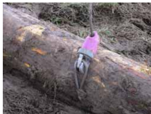
日本製のラジコン式自動荷外しフック
