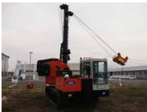
3 胴式ランニングスカイライン用の タワーヤーダと特殊搬器
