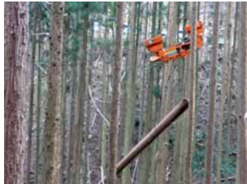
材の先端（荷掛け部）を浮かせた（鼻上げ）集材
