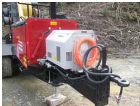
装着されたエアブレーキ用コンプレッサ
