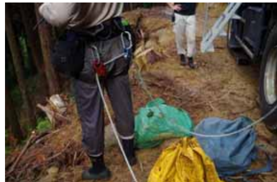
腰部の滑車で繊維製リードロープを引き回し
