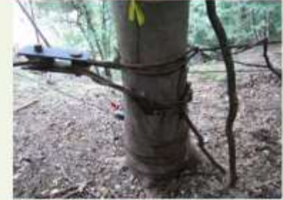
27 サドルブロックで主索の方向を変える
