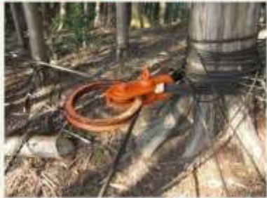
28 リングサドルの正しい使用例
