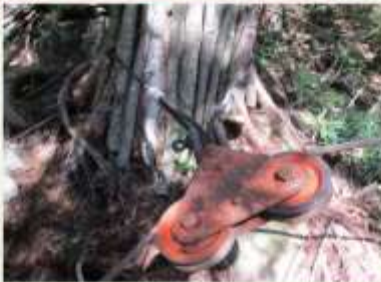
26 サドルブロックで主索の方向を変える
