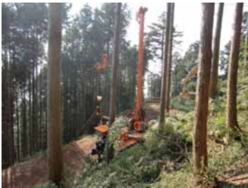
中型タワーヤードと自動繫留搬器の組み合わせ
