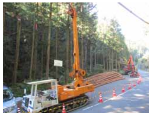
簡易架線集材装置（非主索型の索張り方式）
