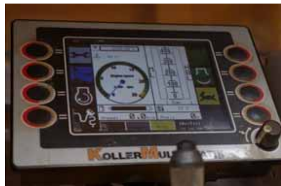
タワーヤードに搭載されているモニター
