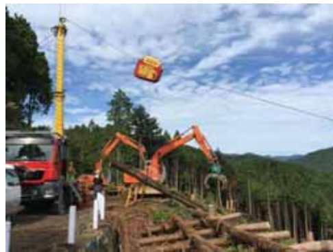
大型タワーヤードと自走式搬器の組み合わせ
