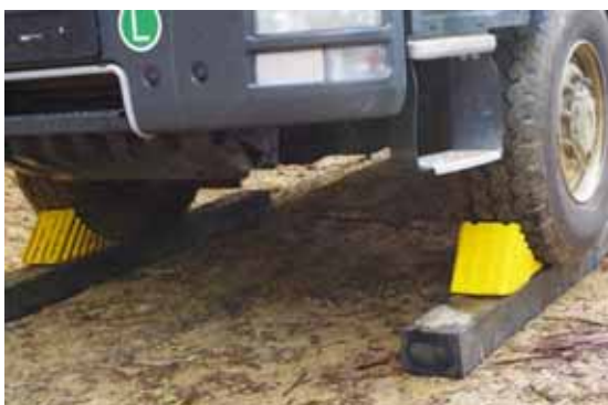
角材で車体を水平に近づけ輪止めで逸走を防止
