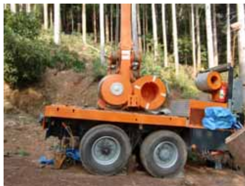
チルト機能で調整されたタワー
