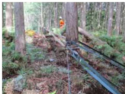
ラッシングベルトを利用したアンカーライン
