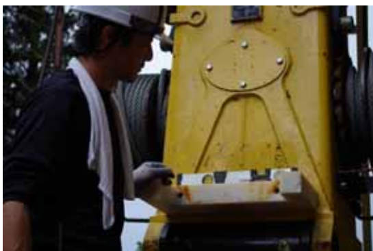
水準器でタワーの直立性を最終確認
