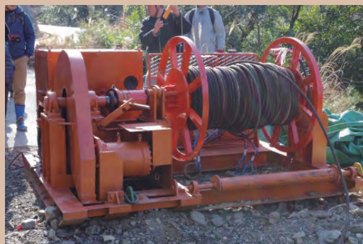
主索巻き取り機で撤収を簡易化
