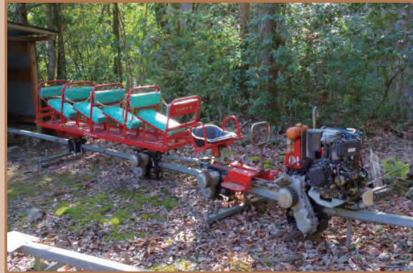
作業員の移動用モノレール
