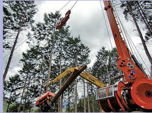
欧州のタワーヤーダを利用した間伐作業
