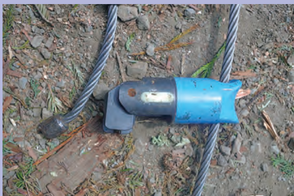
欧州製のラジコン式自動荷外しフック
