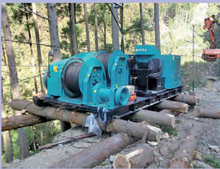
完全油圧式集材機
