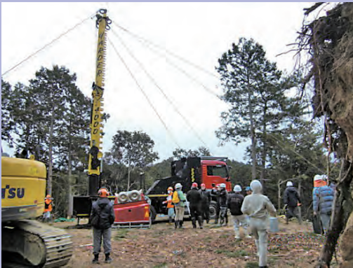
欧州製のトラック搭載型タワーヤード
