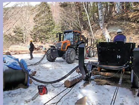
油圧式集材機（写真の動力源は外国製トラクタ）
