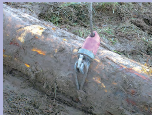
日本製のラジコン式自動荷外しフック
