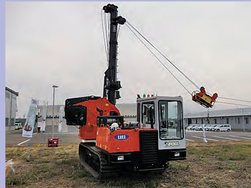
日本製のクローラ型タワーヤード
