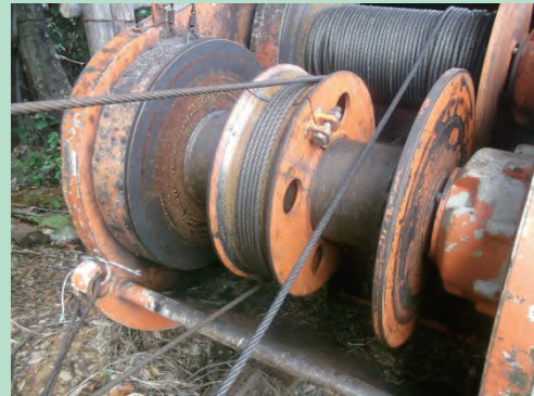
フロントドラムに取り付けられた割エンドレスドラム
