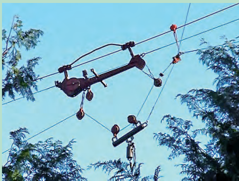
コレクター集材に用いる搬器 (ホイスタチングキャレージを使用した例)
