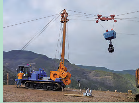
ローディンググラップル搬器と 組み合わせた集材作業
