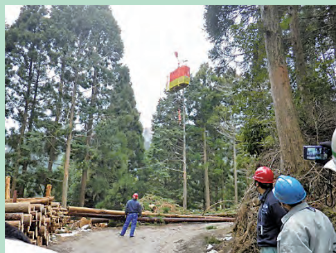
集材作業に巻上索内蔵型搬器を使用
