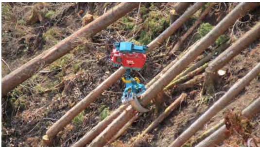
架線式グラップルと油圧集材機での集材
