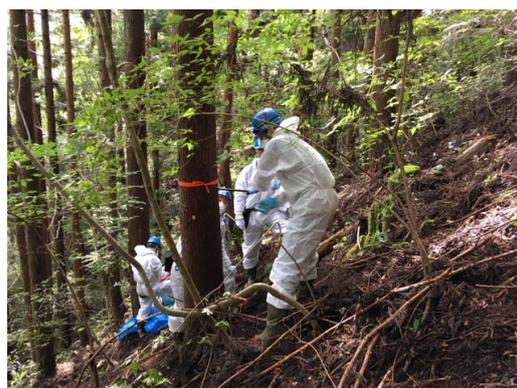
写真 1 空間線量率を測定している様子 写真 2 幹材を採取している様子
