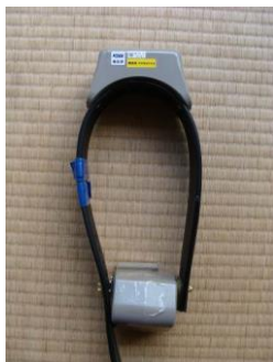
写真 3-1-1 Vectronic 社製 GPS 首輪 Vertex
