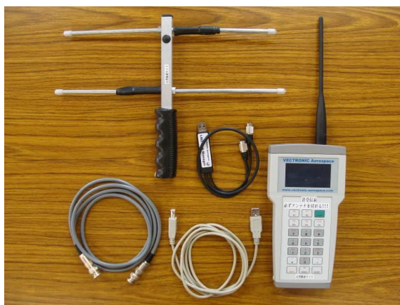
写真 3-1-2 Vectronic 社製 GPS 首輪データ交信用ターミナル
