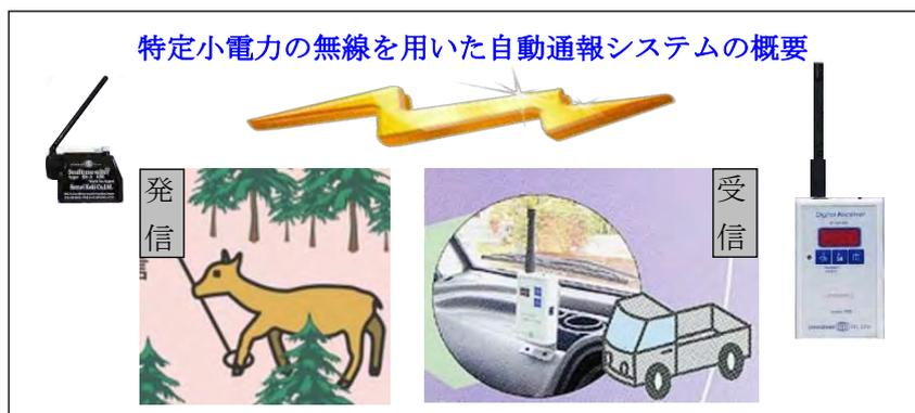
図 3.2.2 ICT 技術の自動通報システムの概要（特定小電力無線自動通報システム）
