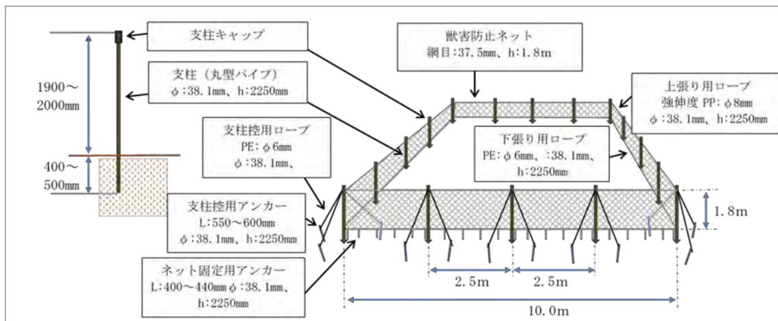
図2-54 パッチディフェンスの設置イメージ
