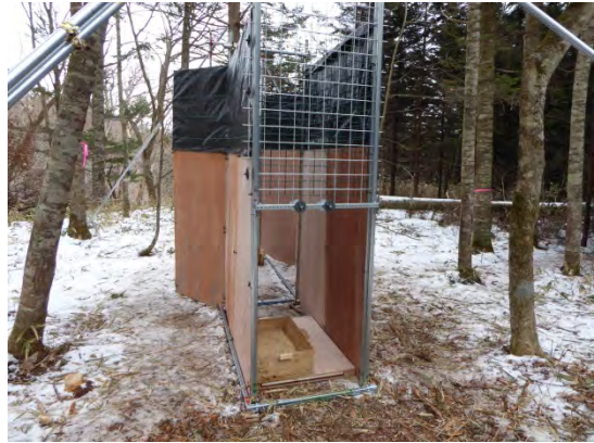
写真 3-11 体重計測式囲いわな (左) No.2 (266 林班) (右) No.5 (292 林班)
