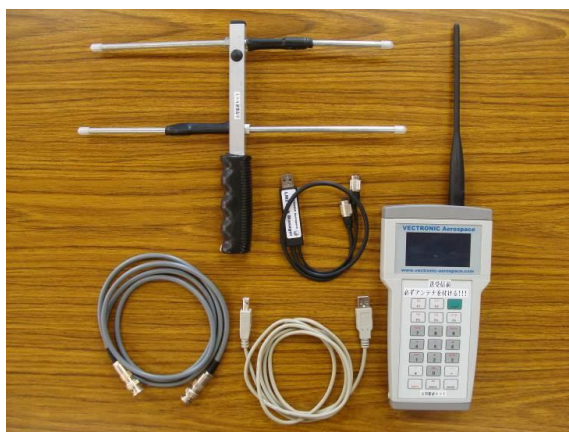
写真 3-1-2 Vectronic 社製 GPS 首輪データ交信用ターミナル
