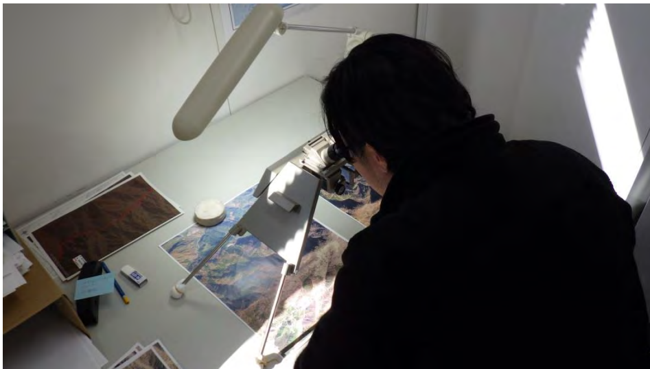
写真 4.2.3 反射式実体鏡を用いた空中写真の実体視
