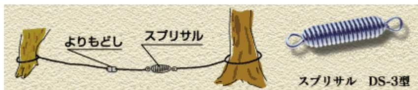
図 4.6.6 スプリサルの仕組み
