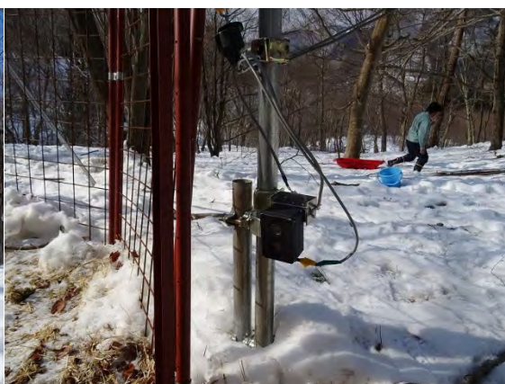
写真 5-10 センサーとマグネットトリガー
