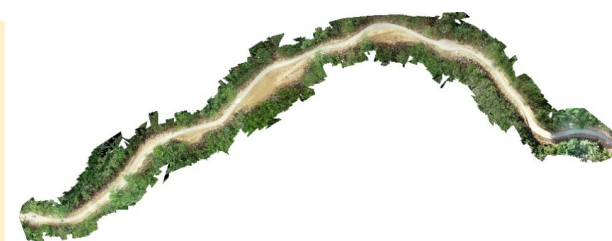
オルソ画像を活用した進捗管理（完成時）
