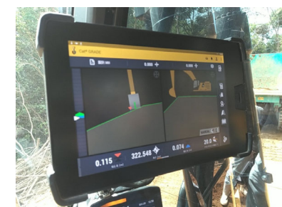
自動追尾式トータルステーションを活用したICT建設機械の活用
