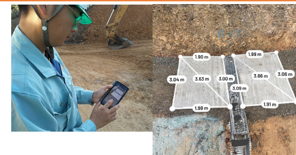
携帯端末のLiDAR機能を用いた点群作成と測量検証
