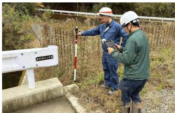
写真 6-2 植生の刈り払いと角にポールを当てて測量している事例
