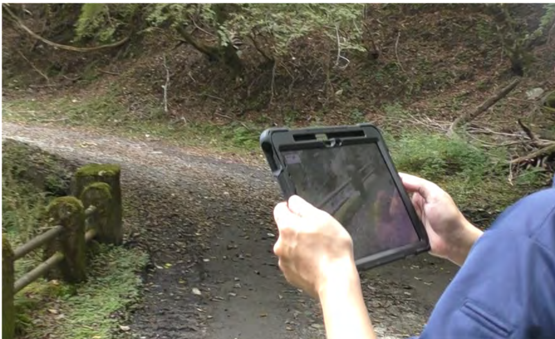
写真 3-10 Pix4DCatch による測量実施状況
