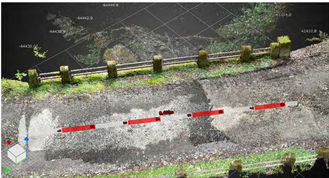
図 3-18 LiGripO1lite 計測結果 (橋長：8.40m 計測：8.40m 誤差 0.00m)
