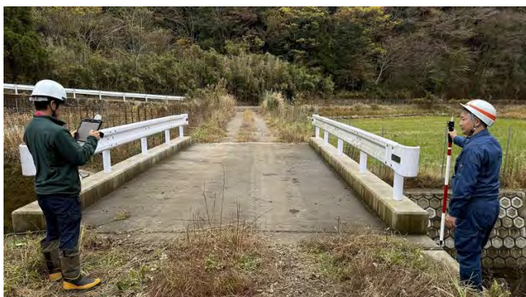
写真 5-5 Pix4DCatch の測量状況
