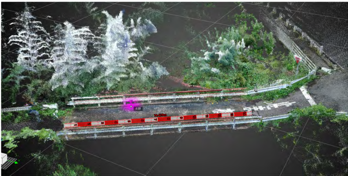
図 3-9 LiGripOllite 計測結果 (橋長：14.44m 計測：14.43m 誤差-0.01m)
