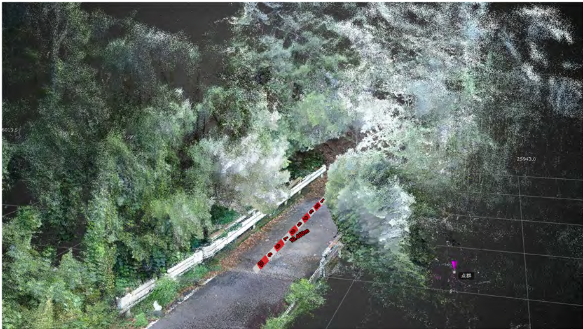
図 3-12 LiGripO1lite 計測結果 (橋長：10.44m 計測：10.46m 誤差 0.02m)
