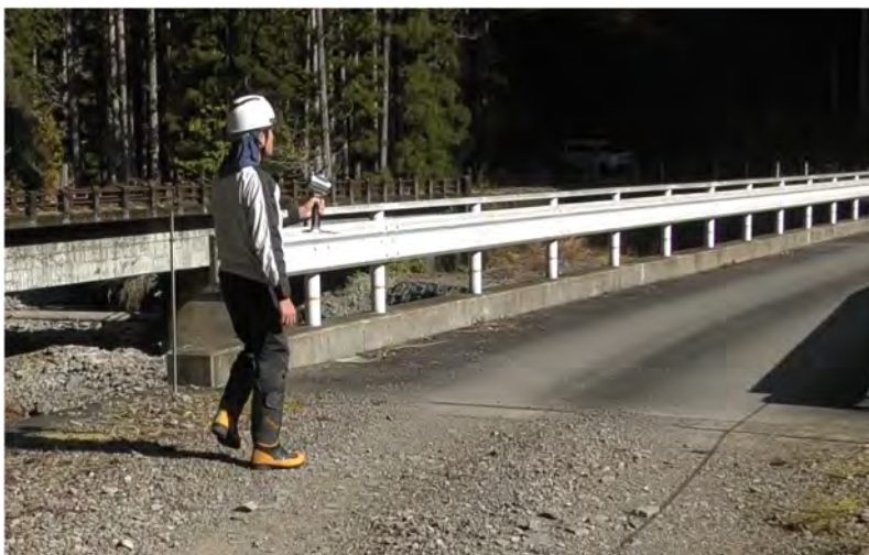
写真 5-2 LiGripO1lite での計測状況
