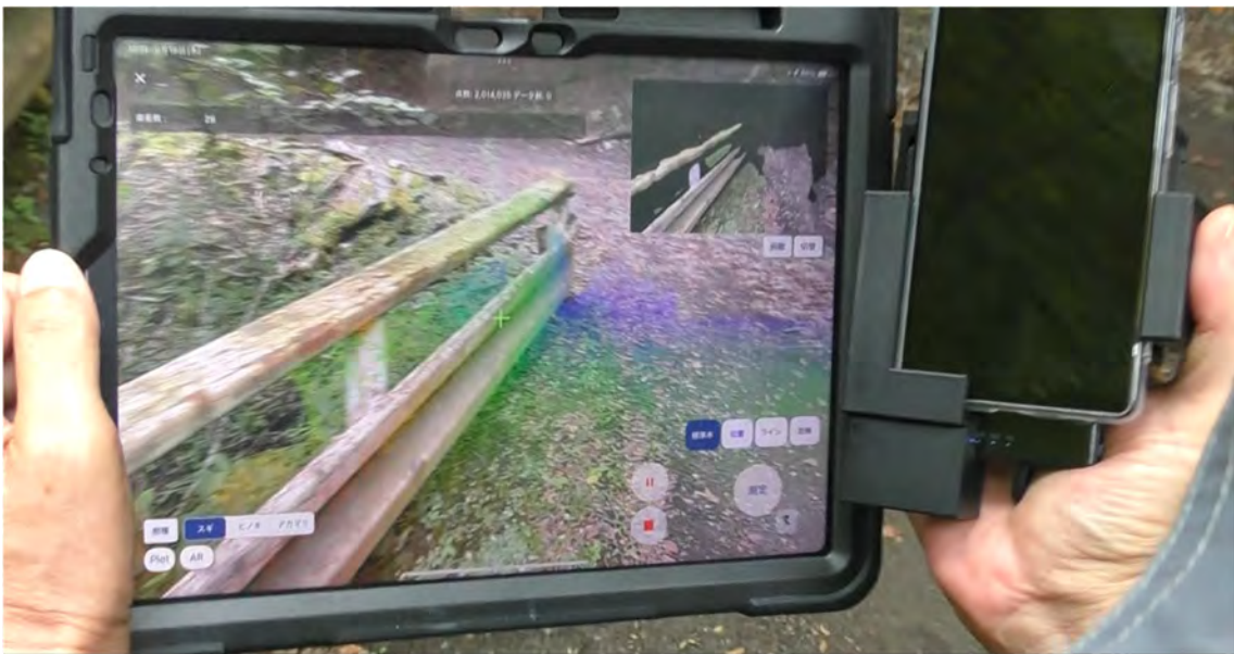
写真 3-8 Mapry による測量実施状況
