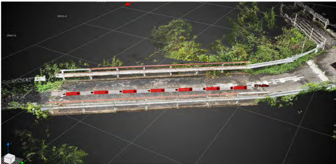
図 3-7 Pix4DCatch 計測結果 (橋長：14.44m 計測：14.37m 誤差-0.07m)
