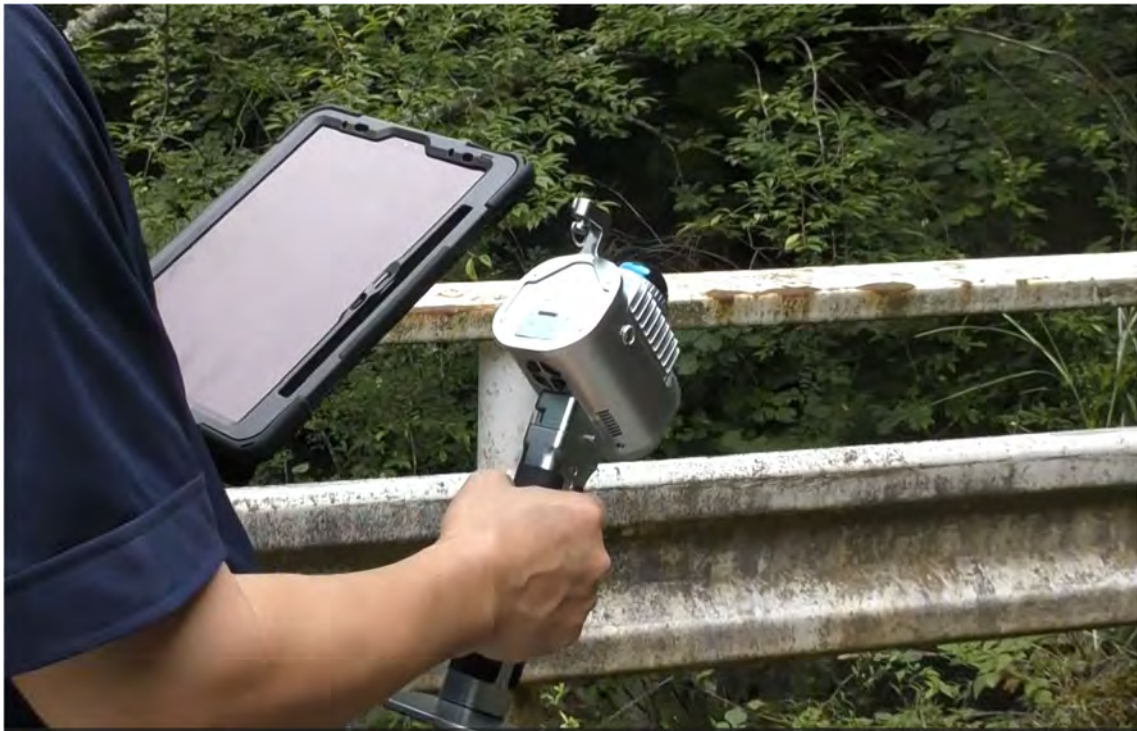
写真 3-9 LiGripO1lite による測量実施状況
