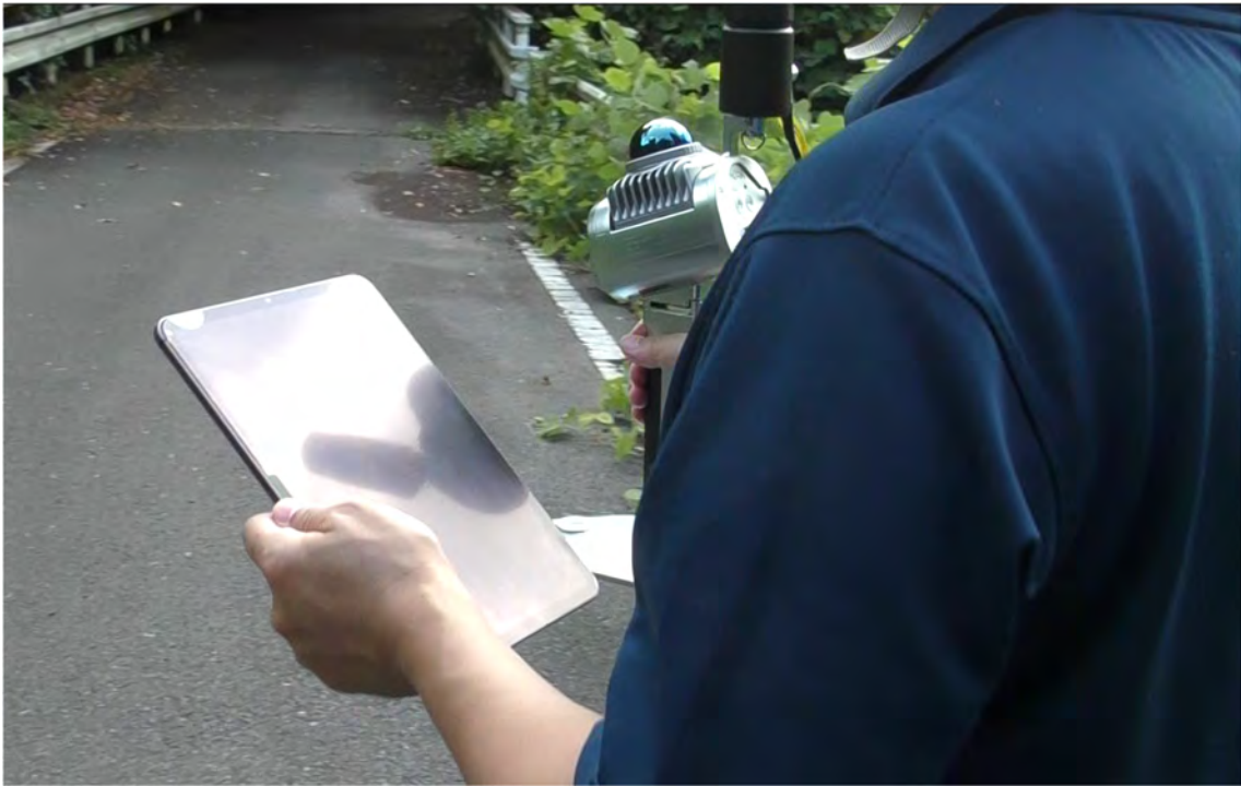
写真 3-6 LiGripO1lite による測量実施状況
