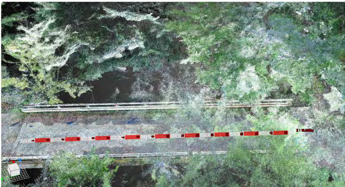
図 3-15 LiGripOllite 計測結果 (橋長：18.40m 計測：18.39m 誤差-0.01m)
