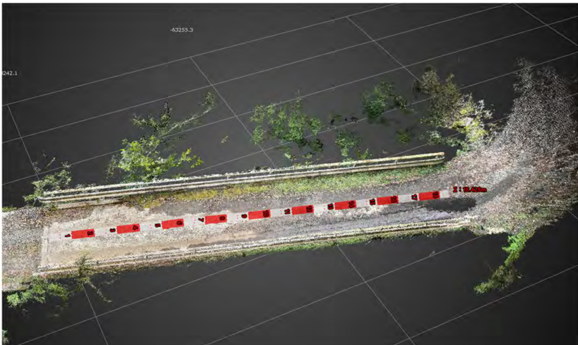
図 3-13 Pix4DCatch 計測結果 (橋長：18.40m 計測：18.43m 誤差 0.03m)
