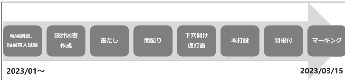
図-6 施工フロー
