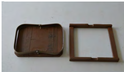
写真6 屈曲板と木枠
