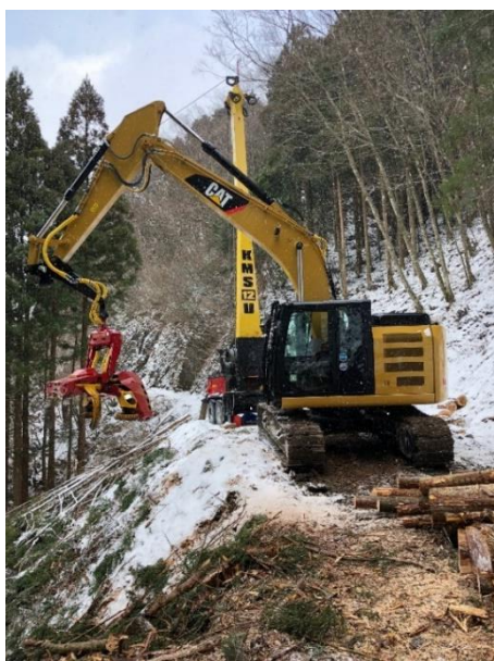
(大径材対応可能な海外製のハーベスタヘッド)
