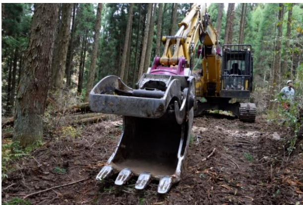
(作業道開設用のフェラーバンチャーザウルス)
