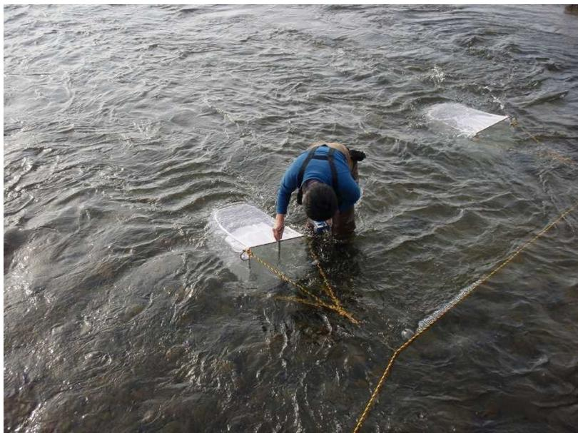
写真 6. 電磁流速計を使用して網口流速を計っている様子
