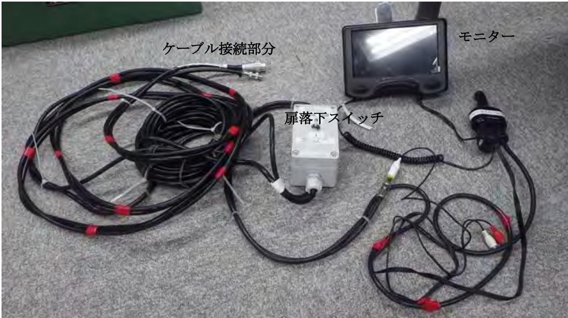
写真 12. 捕獲装置のモニターと扉落下スイッチのセット.
