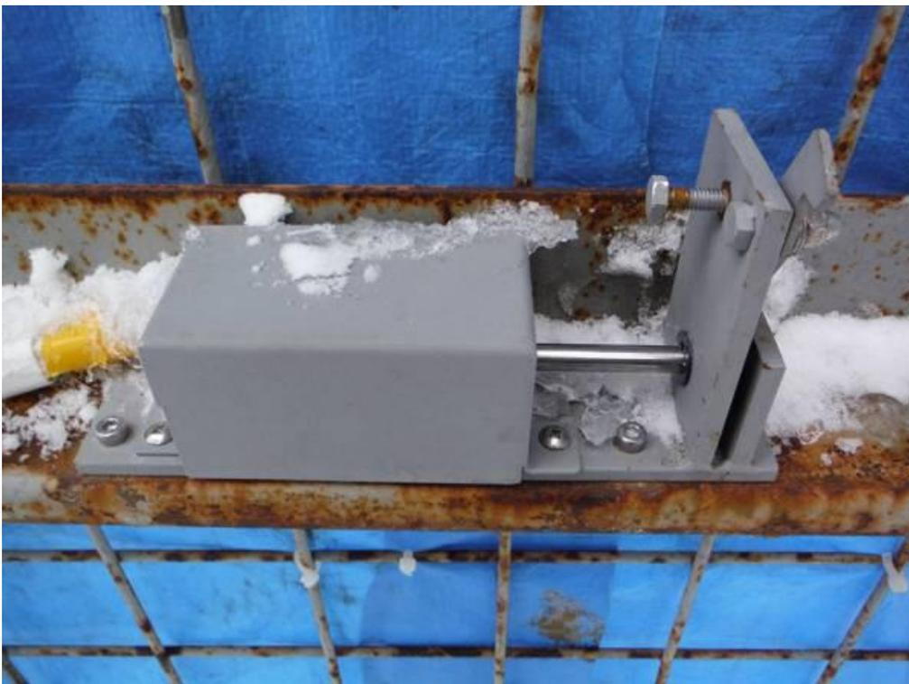
写真 8. 鋼製落とし扉の外枠(下半分の二重部)上部に取り付けたトリガー部分(扉閉鎖時).
