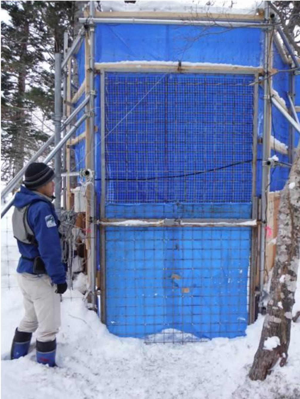
写真 4. エゾシカ捕獲用の鋼製落とし扉の外観（扉閉鎖時）.
