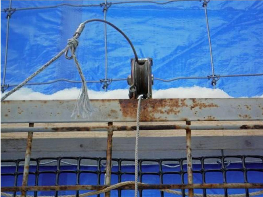
写真 7. エゾシカ捕獲用鋼製落とし扉の外枠上部に取り付けられた滑車（扉閉鎖時）.
